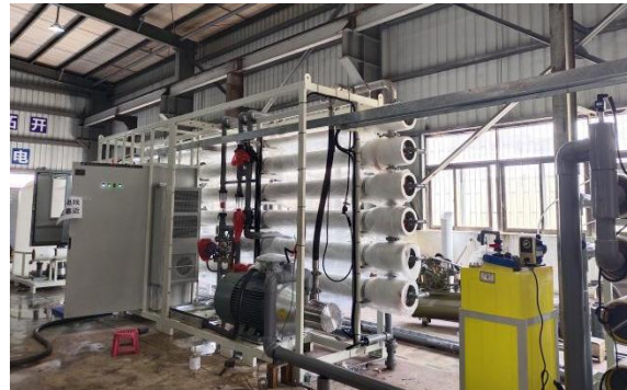
苦咸水淡化 (DHP46, 60bar)
