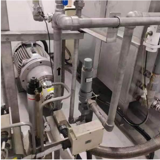
高压清洗 (BHP80, 80bar)
