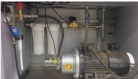
高压清洗 (BHP80, 80bar)
