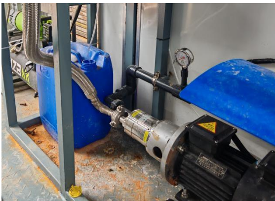
高压喷雾 (BHP5.0, 80bar)
