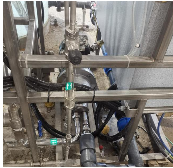
高压输送 (BHP32, 50bar)
